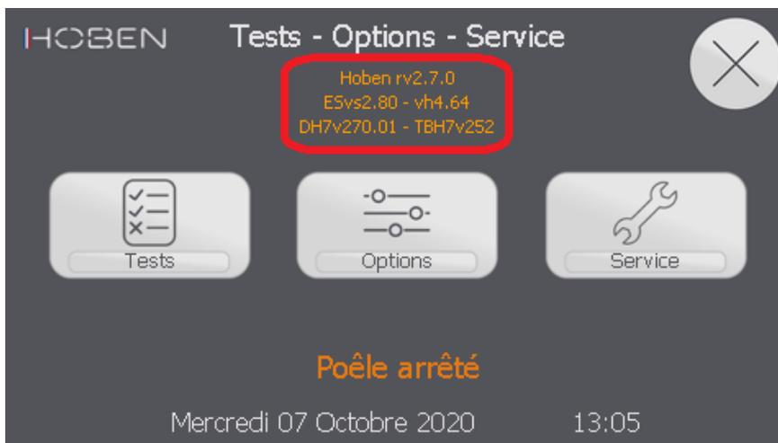
La version logicielle (ici 2.7.0) ainsi que le modèle de poêle est affichée (ici H7)
