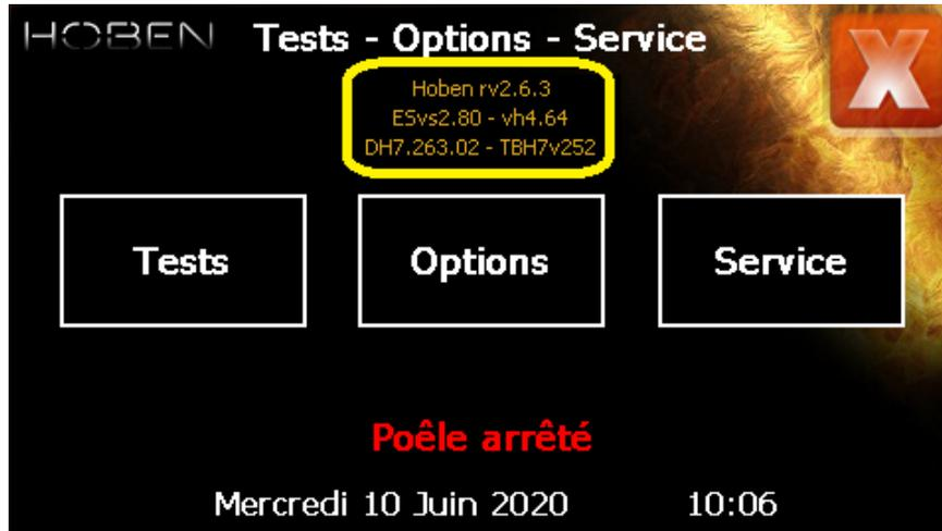
La version logicielle (ici 2.6.3) ainsi que le modèle de poêle est affichée (ici H7)
